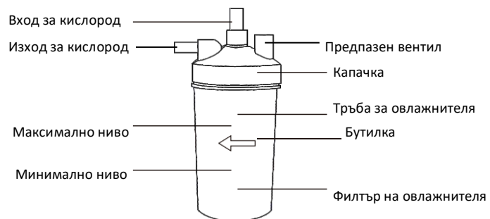
Фигура 5: Компоненти на овлажнителя
